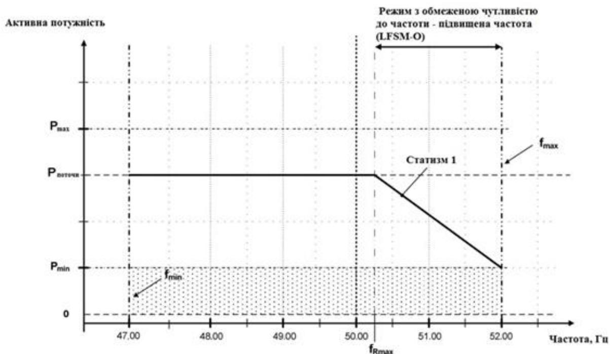
$P_{max}$ ,  $P_{min}$  - максимальний, мінімальний технічний рівень потужності генеруючої одиниці;  $P_{potoch}$  - поточний рівень потужності;  $f_{Rmax}$  - максимальне значення зони нечутливості по частоті;  $f_{min}$ ,  $f_{max}$  мінімальна, максимальна допустима частота роботи генеруючої одиниці.
