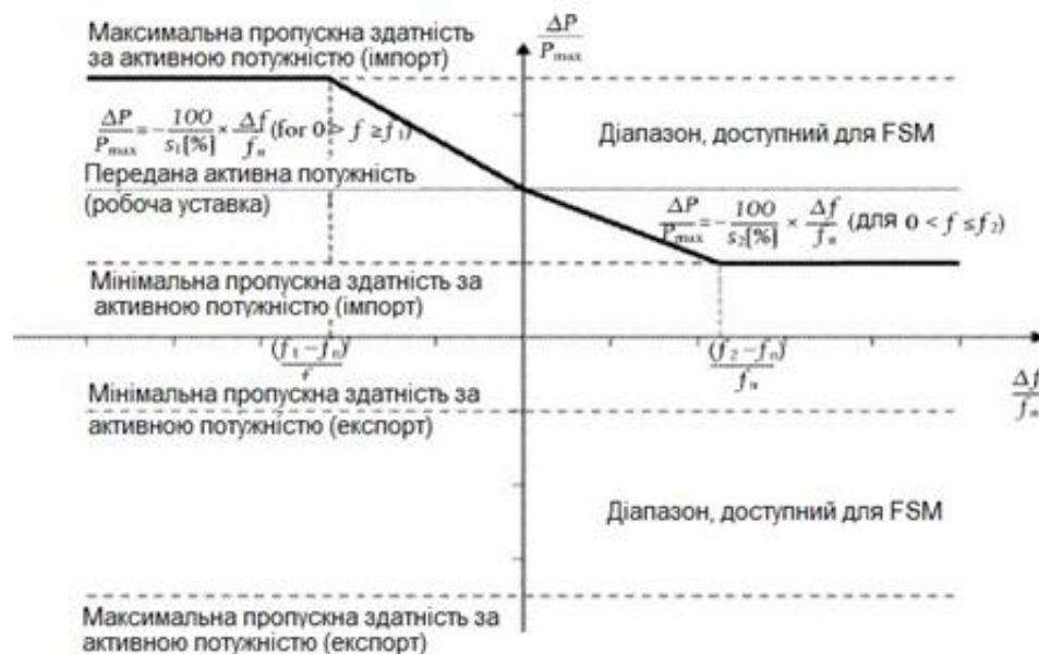
Рисунок ілюструє випадок нульової зони нечутливості і нечутливості з позитивною уставкою активної потужності (режим імпортування).  $\Delta P$  - зміна вихідної активної потужності системи ПСВН.  $f_n$  - цільова частота в мережі ЗС, де надається послуга FSM, а  $\Delta f$  - відхилення частоти в мережі ЗС, де надається послуга FSM.
