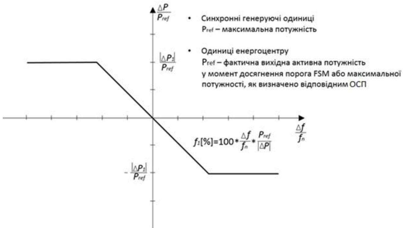
$P_{ref}$  - базова активна потужність, до якої відноситься  $\Delta P$ ;  $\Delta P$  - зміна вихідної активної потужності генеруючої одиниці;  $f_n$  - номінальна частота (50 Гц) у мережі;  $\Delta f$  - відхилення від номінальної частоти в мережі.
