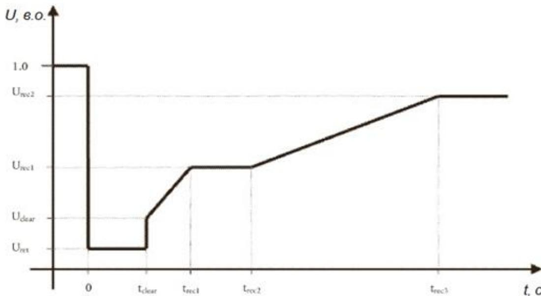
На графіку показана нижня межа кривої напруги в залежності від часу для напруги в точці приєднання, вираженої як відношення її фактичного значення до її опорного значення у в. о. - до, упродовж і після пошкодження.  $U_{ret}$  - залишкова напруга в точці приєднання впродовж КЗ,  $t_{clear}$  - момент ліквідації КЗ.  $U_{rec1}$ ,  $U_{rec2}$ ,  $t_{rec1}$ ,  $t_{rec2}$  і  $t_{rec3}$  - вказують на певні точки нижніх меж відновлення напруги після ліквідації КЗ.
