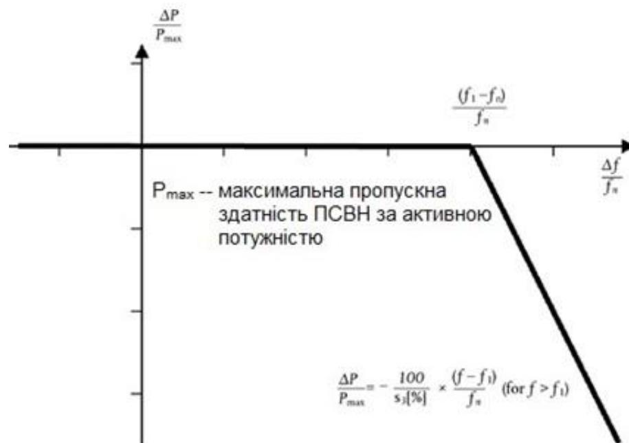
**ΔР** - зміна вихідної активної потужності системи ПСВН і залежно від робочих режимів зменшення імпортованої потужності або збільшення експортованої потужності.  $f_n$  - номінальна частота мережі або мереж ЗС, до яких приєднана система ПСВН, а **Δf** - зміна частоти в мережі або мережах ЗС, до яких приєднана система ПСВН. За підвищених частот, коли  $f$  перевищує  $f_1$ , система ПСВН повинна зменшувати активну потужність відповідно до уставки статизму.
