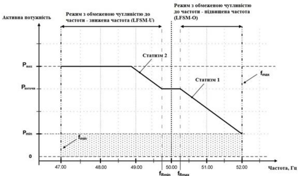
$P_{max}$ ,  $P_{min}$  - максимальний, мінімальний технічний рівень потужності генеруючої одиниці;  $P_{поточн.}$  - поточний рівень потужності.  $f_{Rmin}$ ,  $f_{Rmax}$  - мінімальне, максимальне значення зони нечутливості по частоті;  $f_{min}$ ,  $f_{max}$  мінімальна, максимальна допустима частота роботи генеруючої одиниці.
